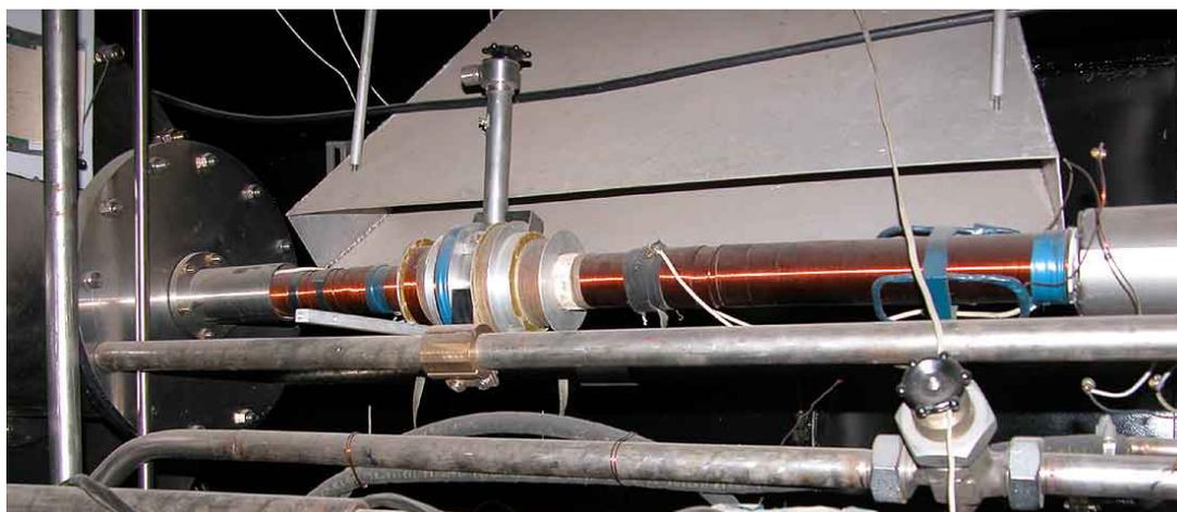
**Рис. 11. Внешний вид канала транспортировки электронов от пушки.**
