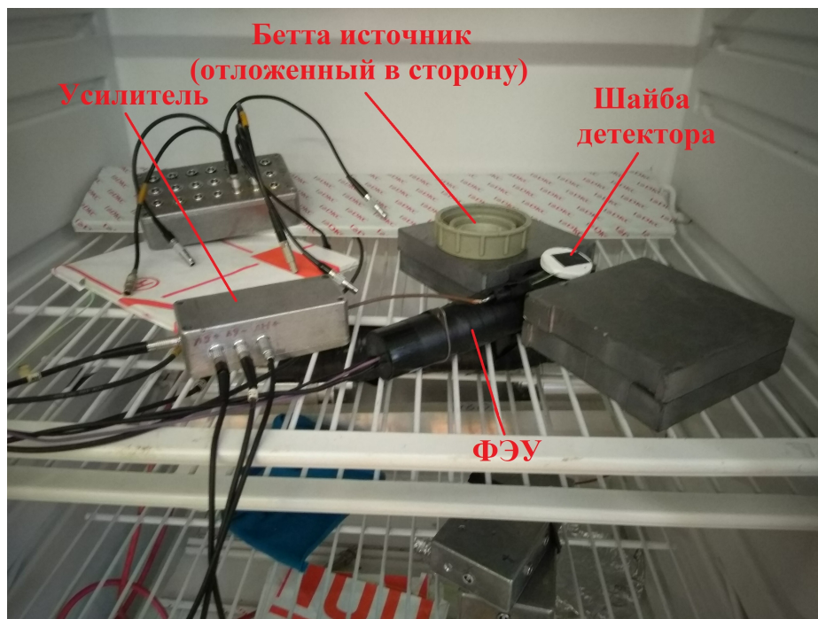
Рисунок 3.7 — Фотография конфигурации шайбы, SiPM и ФЭУ на измерительном стенде.
