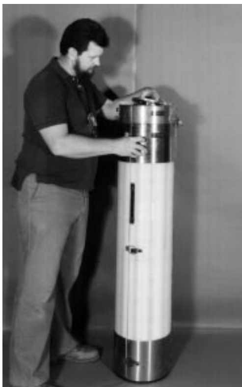
Рис. 17.13. Универсальный счетчик нейтронных совпадений UFBR для проверки кассет топливных стержней реактора-размножителя на быстрых нейтронах. В счетчике использована новая схема АМРТЕК
