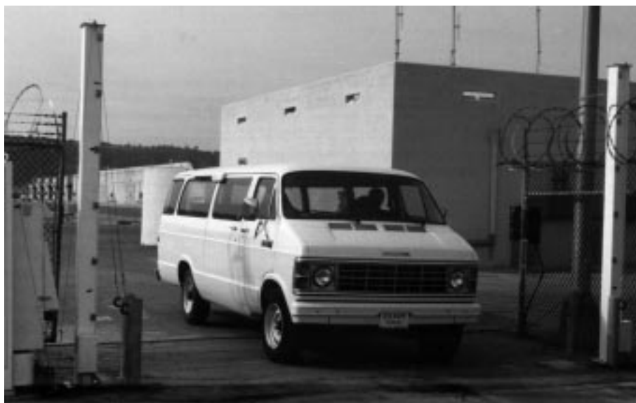
Рис. 19.17. Портальный монитор ядерных материалов проверяет автотранспорт, медленно (скорость — 8 км/ч) проезжающий между колоннами с детекторами
