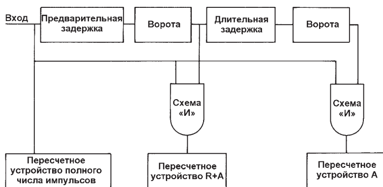
Рис. 16.7. Схема совпадений с продлеваемым мертвым временем на двух одновибраторах равной длительности
