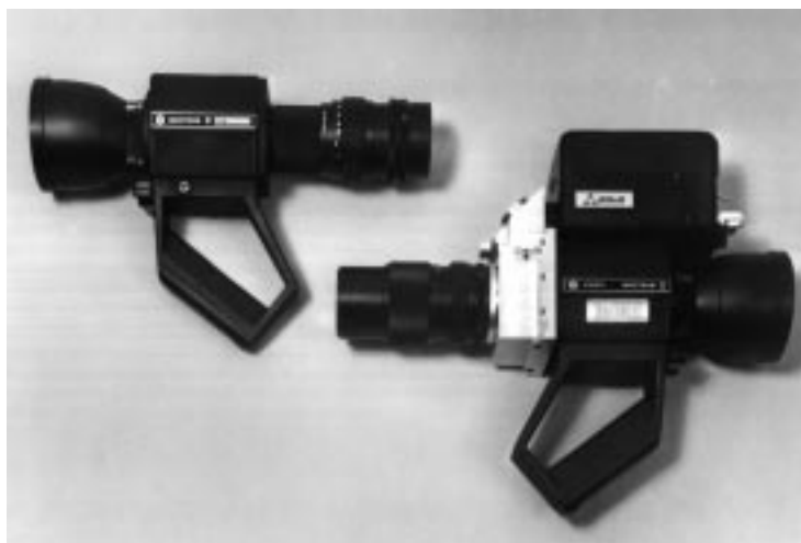
Рис. 18.16. Переносной прибор наблюдения черенковского свечения облученного топлива и определения его интенсивности. Прибор (справа) является адаптацией промышленного прибора ночного видения (слева)
