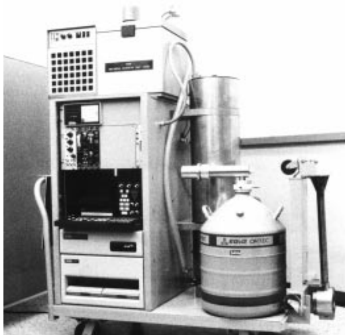
Рис. 22.6. Маундская система для одновременного калориметрического измерения мощности и гамма-спектрометрического определения изотопного состава. Сбоку виден германиевый детектор, при измерении размещаемый напротив корпуса калориметра. (Фотография предоставлена Маундской лабораторией)
