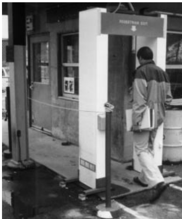
Рис. 19.1. Автоматический портальный монитор ядерных материалов с пластмассовыми сцинтилляторами большой площади для контроля пешеходов
