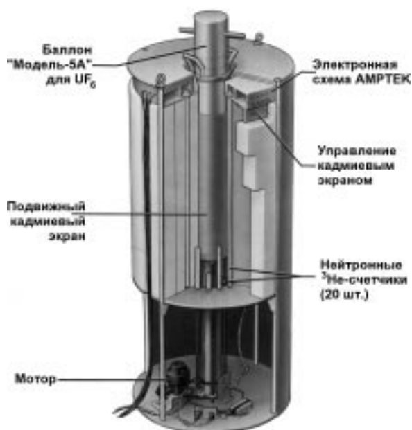
Рис. 17.32. Монитор RAM входного контроля для проверки содержания ^{235}\text{U} в \text{UF}_6 в баллонах типа "Модель-5А"
