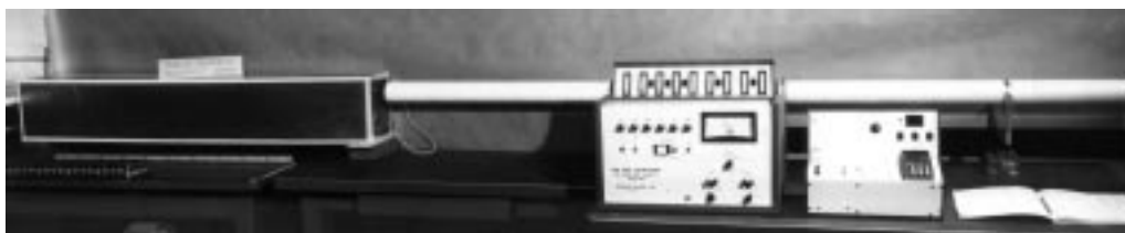
Рис. 22.8. Аргонная калориметрическая система для топливных стержней (модель 4 для топливных стержней длиной 1 м), содержащая калориметр (слева), нагреватель предварительного нагрева (длинный белый цилиндр) и блок электроники. (Фотография предоставлена Аргонской национальной лабораторией)
