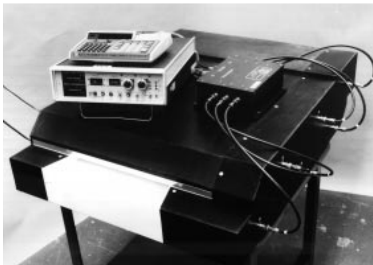
Рис. 17.11. Счетчик для контроля топливных стержней, используемый при проверке лотков со стержнями для реактора-размножителя на быстрых нейтронах. Блок сдвигового регистра и соединительная коробка с предусилителем находятся наверху детектора
