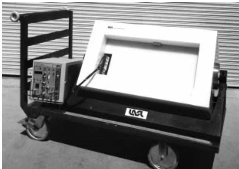
Рис. 15.4. Плоский детектор с направленной защитой, разработанный для контроля обогащения UF_6
