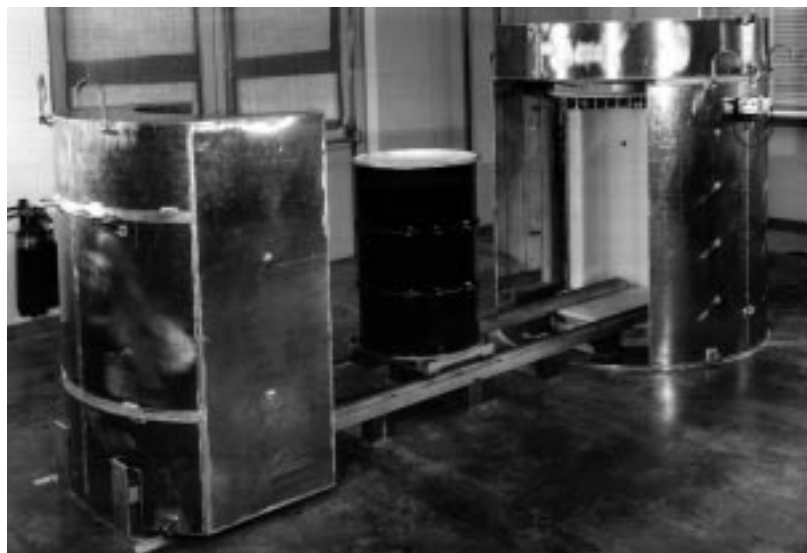
Рис. 17.2. Пассивный счетчик нейтронных совпадений для 200-литровых бочек
