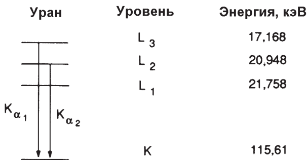
Рис. 1.4. Электронные энергетические уровни урана. Показан переход между уровнями с испусканием рентгеновских квантов K-серии
