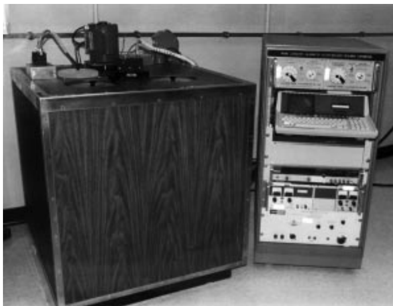
Рис. 22.5. Маундский серийный двухэлементный мостовой калориметр. Водяная ванна (слева) содержит два двухэлементных мостовых калориметра. (Фотография предоставлена Маундской лабораторией)
