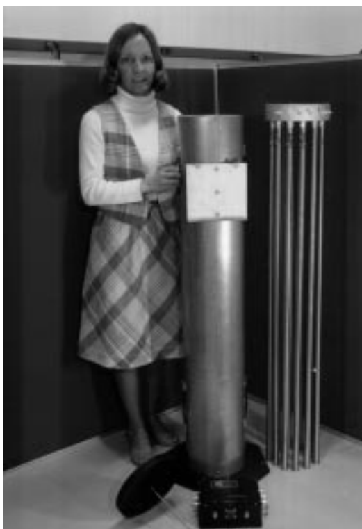
Рис. 17.12. Цилиндрический счетчик нейтронных совпадений для контроля кассет топливных стержней реактора-размножителя на быстрых нейтронах
