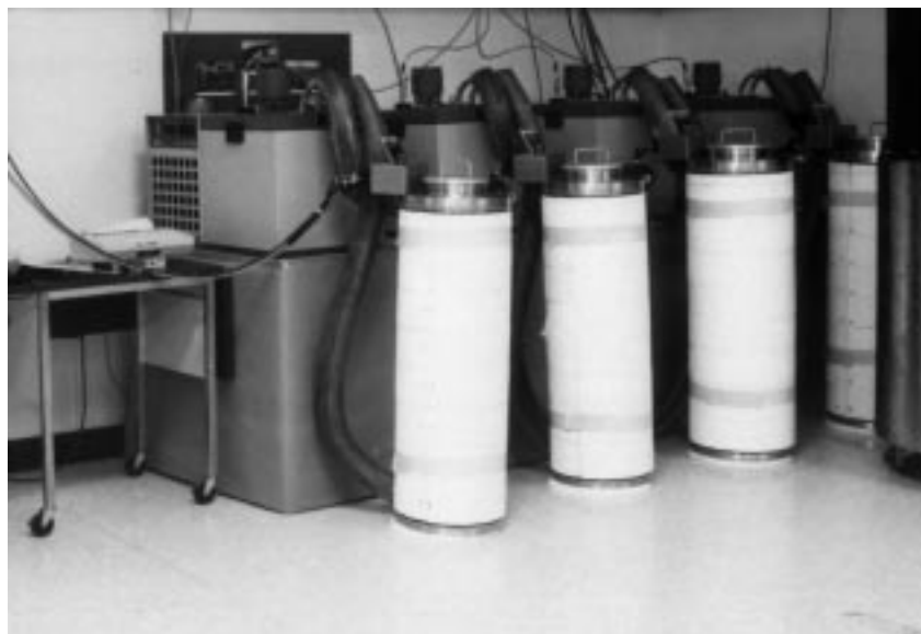
Рис. 22.7. Комплект из четырех Маундских градиентных мостовых калориметров. Два калориметра имеют камеры для образцов диаметром 11 см, а два другие — камеры для образцов диаметром 12,4 см.
