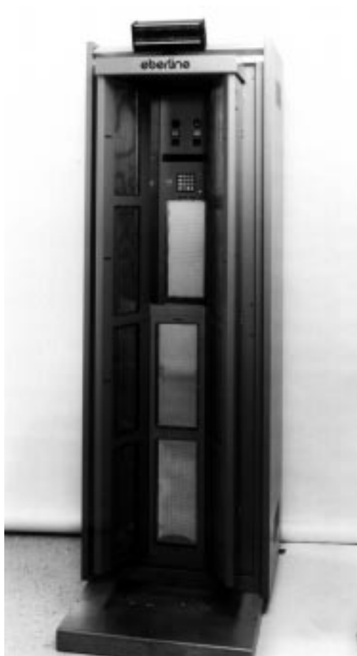
Рис.19.3. Этот чувствительный монитор загрязнения проводит измерения с каждой стороны тела объекта раздельно. Фото предоставлено фирмой Eberline Instrument Corp., Санта-Фе, штат Нью-Мексико
