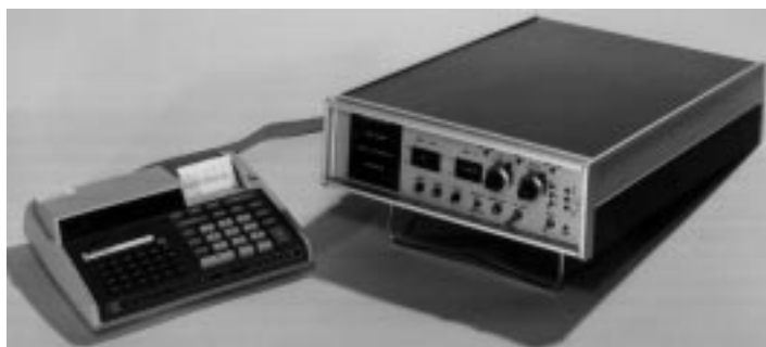
Рис. 17.4. Стандартный блок сдвигового регистра установки HLNCC и программируемый калькулятор HP-97. Это оборудование входит в комплект всех систем, указанных на рис. 17.1
