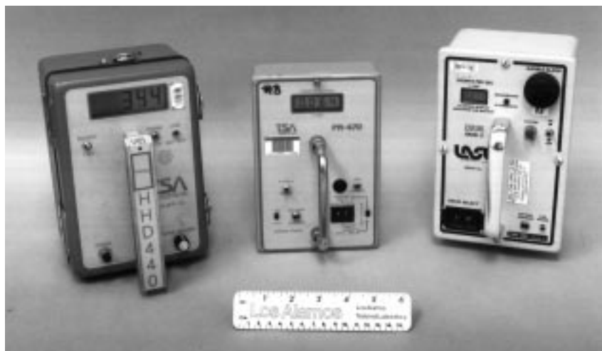
Рис. 19.15. Три ручных монитора ядерных материалов, которые автоматически обнаруживают значительные превышения интенсивности излучения над уровнем фона. Левый и центральный блоки изготовлены фирмой TSA Systems, Inc., Баулдер, Колорадо. Правый блок изготовлен фирмой CMS, Inc., Голета, Калифорния
