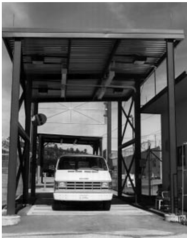
Рис. 19.12. Составные части этого транспортного монитора осуществляют те же самые основные функции, что и составные части пешеходного монитора. Прибор изготовлен фирмой Jomar Systems, Inc., Лос-Аламос, штат Нью-Мексико
