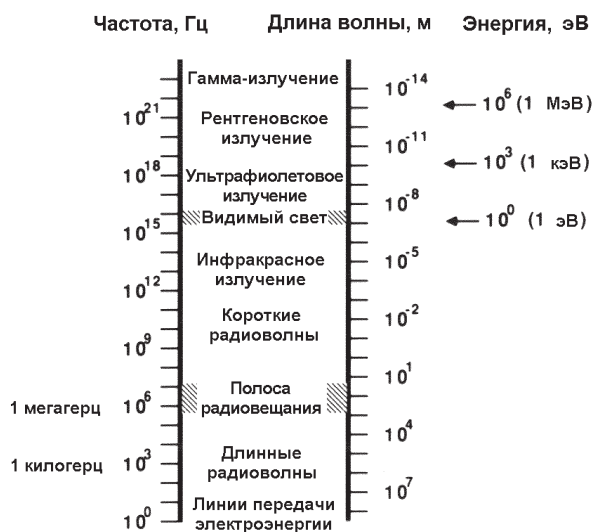
Рис. 1.1. Спектр электромагнитного излучения, отражающий соотношение между параметрами гамма-излучения, рентгеновского излучения, световых волн и радиоволн
