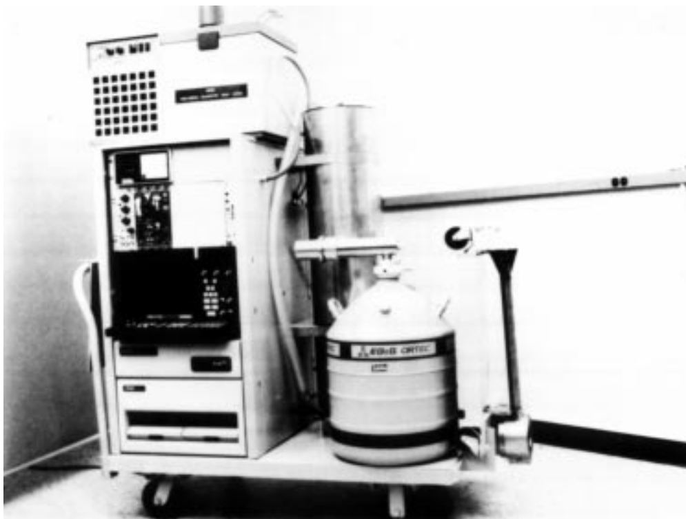
Рис. 8.21. Передвижной калориметр с возможностью одновременного проведения калориметрии/гамма спектрометрии. (Фотография любезно предоставлена Флейшнером, Маундская лаборатория)
