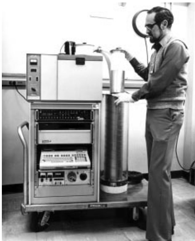
Рис. 22.3. Передвижная Маундская калориметрическая система с контроллером температуры ванны (вверху слева), блоком электроники и системой сбора данных (внизу слева) и мостовым калориметром с верхней/нижней камерами (справа). (Фотография предоставлена Маундской лабораторией)
