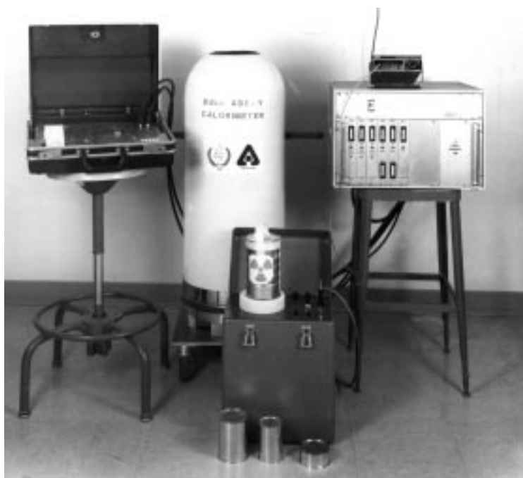
Рис. 22.4. Аргонский калориметр для анализа материалов в балк-форме (в центре) с системой сбора данных (слева), блоком питания схемы управления (справа), камерами предварительного нагрева образцов и калориметрическими контейнерами (на переднем плане). (Фотография предоставлена Аргонской национальной лабораторией)
