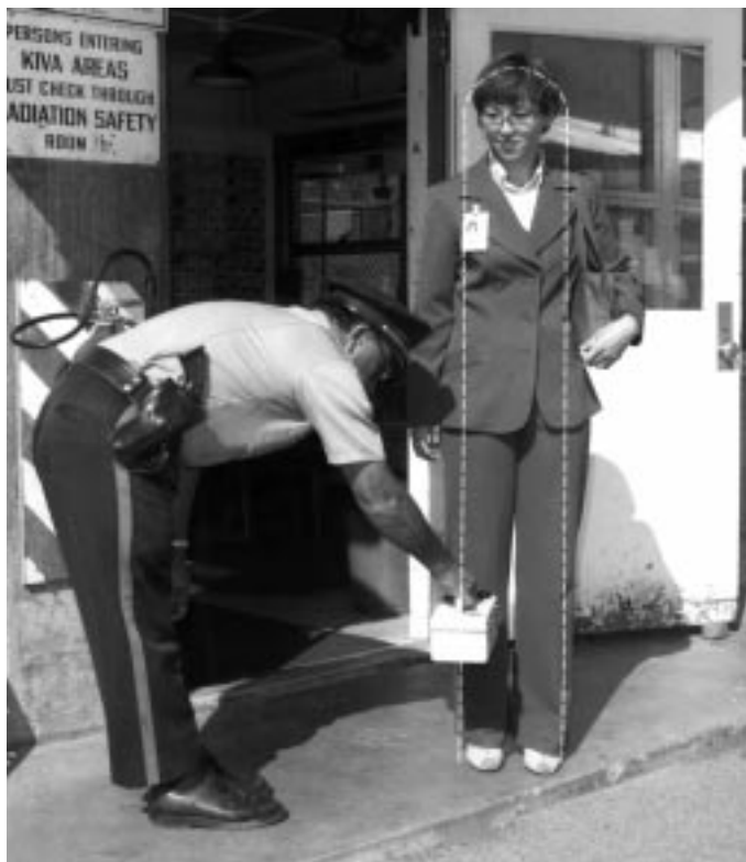
Рис. 19.2. Мониторинг ручными приборами весьма эффективен, если оператор имеет хорошую подготовку и основание для досмотра
