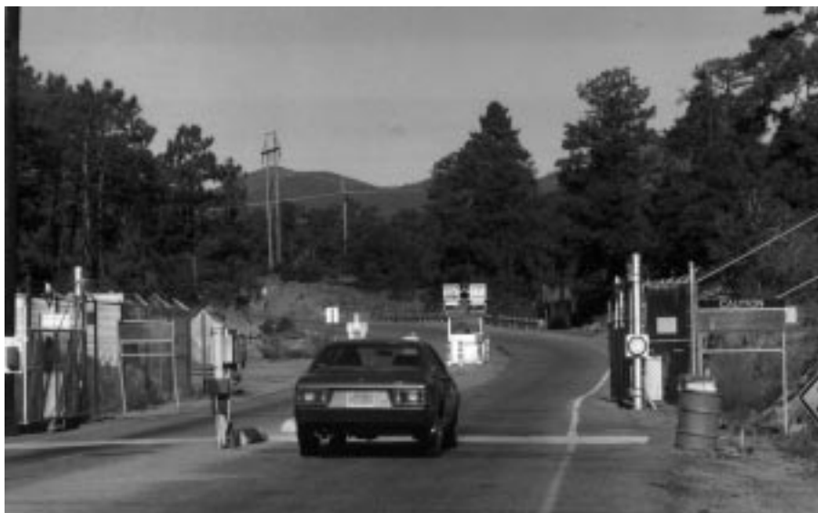
Рис. 19.16. Этот транспортный монитор проверяет активированные материалы, вывозимые с объекта, на котором имеется ускоритель. Расположенный в земле детектор вызывает сигнал тревоги и фотографирует транспортное средство в случае, если система воспринимает интенсивность излучения, вдвое превышающую уровень фона
