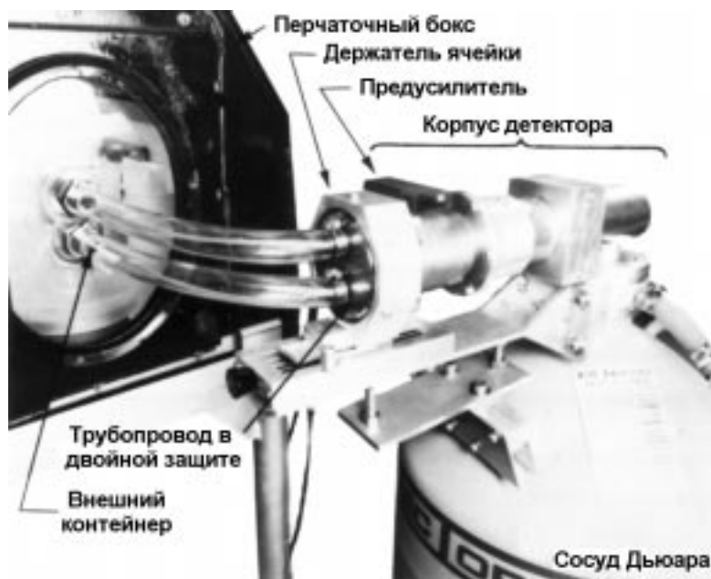
Рис. 8.23. Детектор из особо чистого германия и ячейка для образца системы для анализа изотопного состава плутония, установленной на заводе по переработке ядерного топлива в Токай-Мура, Япония [12]. (Фотография любезно предоставлена Ганнинком, ЛЛНЛ)
