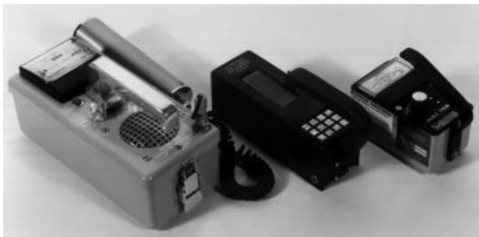
Рис. 19.14. Три различных ручных монитора контроля загрязнения. Слева направо: прибор контроля гамма-излучения со сцинтиллятором NaI, многоцелевой монитор с четырьмя типами детекторов и монитор поверхностного радиоактивного загрязнения со счетчиками Гейгера-Мюллера. Левый и правый приборы изготовлены фирмой Technical Associates, Каногга Парк, Калифорния
