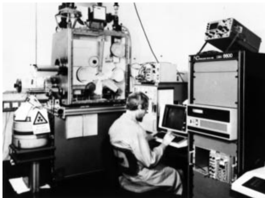
Рис. 9.18. Плотномер К β К по К-краю, аттестуемый по программе ФРГ поддержки МАГАТЭ
