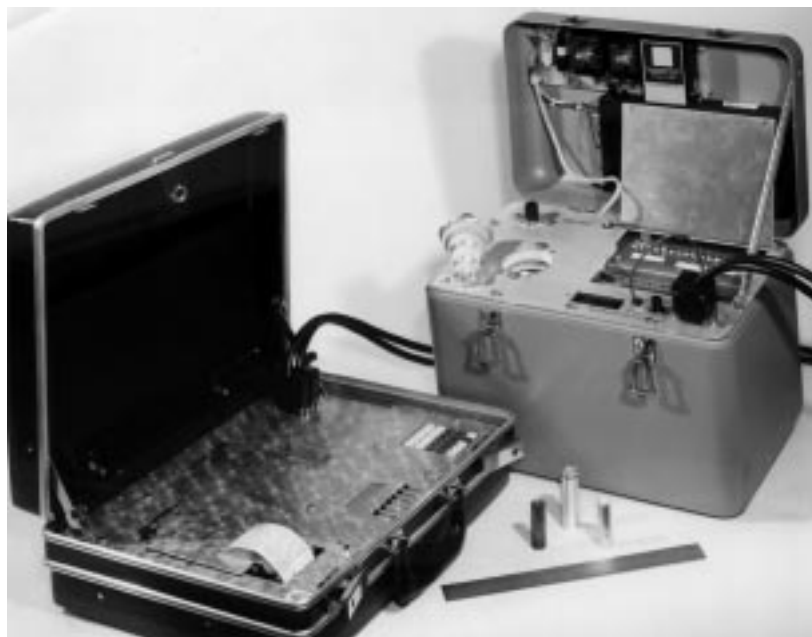
Рис. 22.2. Аргонский калориметр для небольших образцов (справа) и его система сбора данных (слева). (Фотография предоставлена Аргонской национальной лабораторией)
