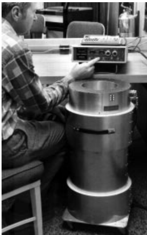
Рис. 17.6. Общий вид установки HLNCC-II. Видны 6 индикаторных лампочек на соединительной коробке наверху блока детектирования и блок сдвигового регистра на столе
