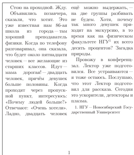
Рис. 7.7. Колонки сбалансированы с помощью пакета balanced , а подстрочное примечание сформировано с помощью стиля ftnright
